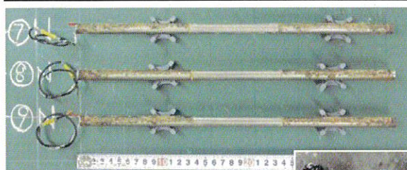
補修材Bの鉄筋腐食状況 [塩分量 5kg/m 3 乾湿繰返し、12サイクル完了後]
